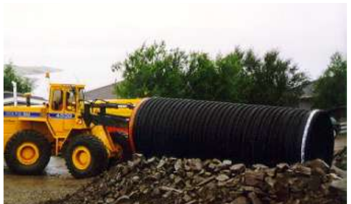
Intern transport av Haplast Profilrør med hjullaster. Gaffelen er påmontert gaffelforlenger slik at løftet foregår kontrollert og uten å skade produktet.
