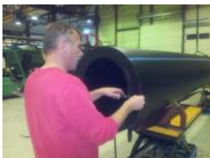
Kontrollmåling under rørproduksjonen
